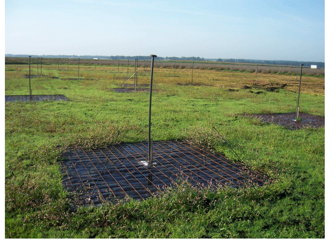
Figure 1.a: LOFAR – Low Band Antennas (LBAs)
